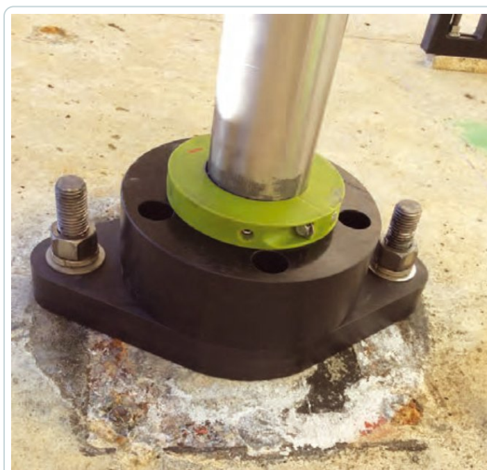
Niemetaliczne łożysko ścienne HMAX — wały obracają się swobodnie, bez smarowania.
